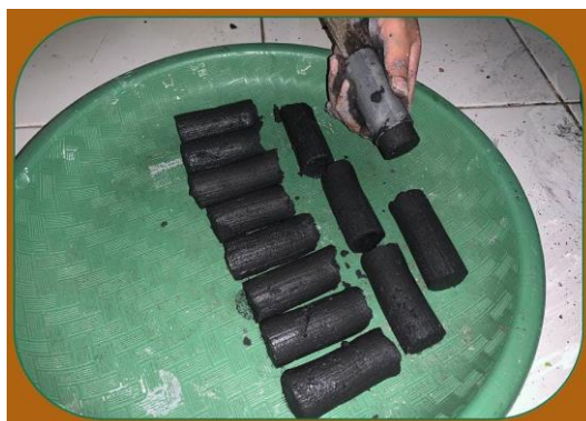
Gambar 3. Proses Peretakan dan Pencetakan menggunakan Pipa
