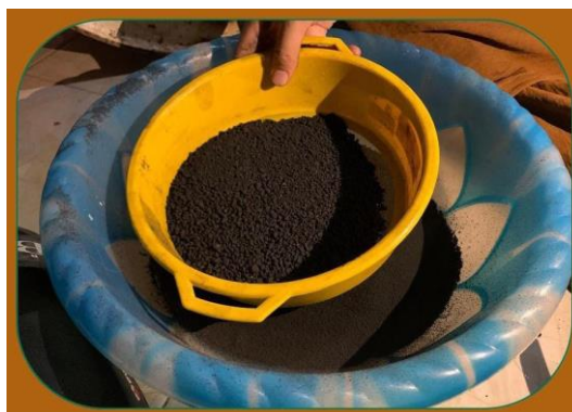
Gambar 2. Proses Tongkol Jagung yang sudah dibakar menjadi Abu dan di saring
