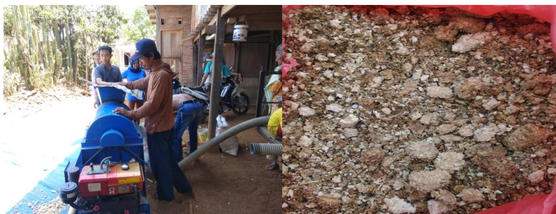
Gambar 2. Proses pencacahan menggunakan mesin dan Janggel jagung hasil cacahan
