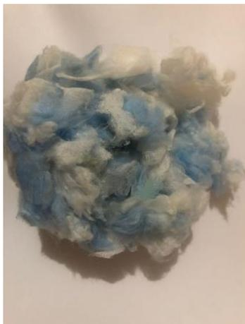
Gambar 3. Hasil Parutan Masker dan siap untuk dicampur ke dalam campuran beton
