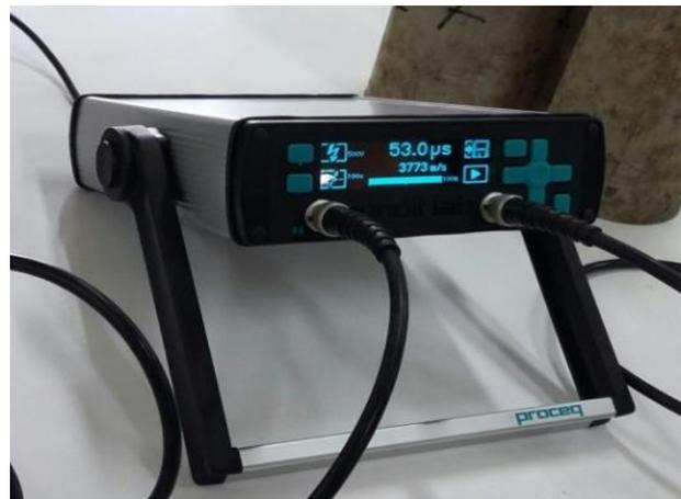
Gambar 4. Pengujian dengan Alat UPV
