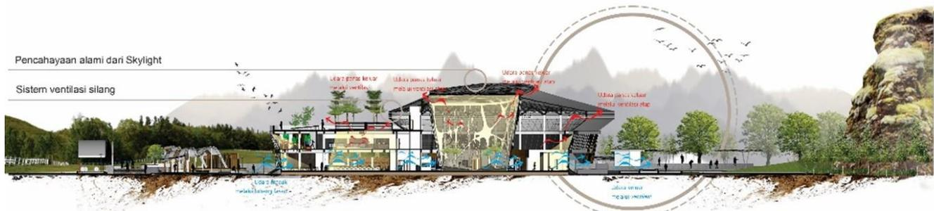
**GAMBAR 7** Skema Penghawaan dan Pencahaya Alam Pada Bangunan
