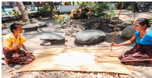
Gambar 2 Seorang ibu sedang membersihkan kapas dengan memukul-mukul berulang kali dengan alat pembersih atau buhu . Tersiap juga gulungan-gulungan kecil kapas bersih atau ogor . (Dokumentasi Sonny Syaputra, Januari 2019)
