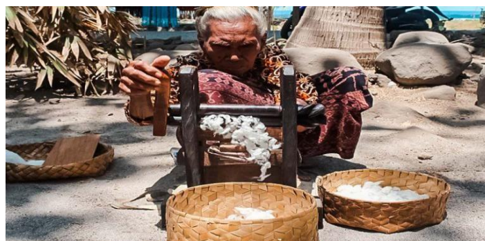
Gambar 1 Seorang ibu sedang memisahkan biji dan kapas pohon dengan alat penggencet atau keho .
